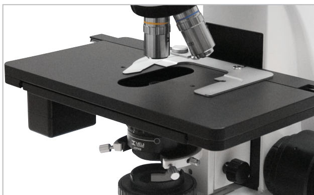
2-х уровневый моторизованный столик
